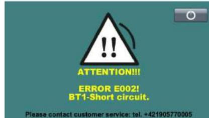
6.9.8) Notification de défaillance du capteur de niveau en cas de débranchement ou court-circuit. Un message d'erreur s'affichera à l'écran. L'unité de contrôle interrompt la procédure, arrête toutes les unités alimentant l'évaporateur en azote liquide et déclenche le moteur de ventilation qui aspire les vapeurs excédentaires de la cabine. Une alarme visuelle de priorité moyenne s'allume, avec un signal lumineux (LED) clignotant jaune. En cas d'erreur, appelez le service de maintenance.
