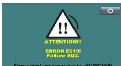
6.9.6) Notification de défaillance du capteur de position de l'opérateur. Un message d'erreur s'affiche à l'écran, et une alarme visuelle de priorité moyenne s'allume, avec un signal lumineux (LED) clignotant jaune. L'unité de contrôle interrompt la procédure et arrête toutes les unités alimentant l'évaporateur en azote liquide. Si cette erreur survient, fermez immédiatement la vanne d'alimentation en azote, débranchez l'alimentation électrique de l'appareil et appelez le service de maintenance.
